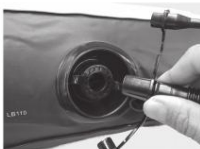
⑤空気がいっぱいになったらポンプノズルの根元を持って引き抜きます。
